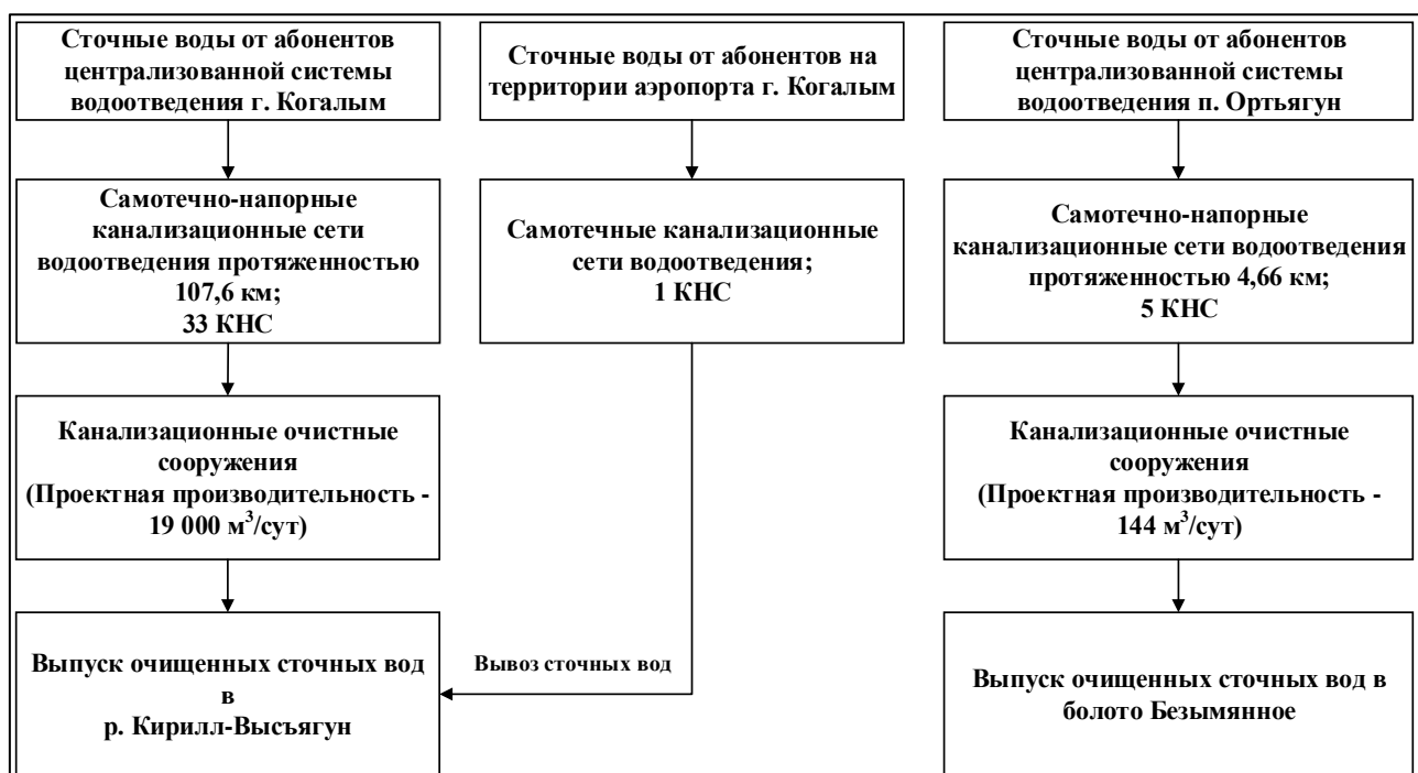
Рисунок 2.1.1. Структурная схема централизованного водоотведения г. Когалым
